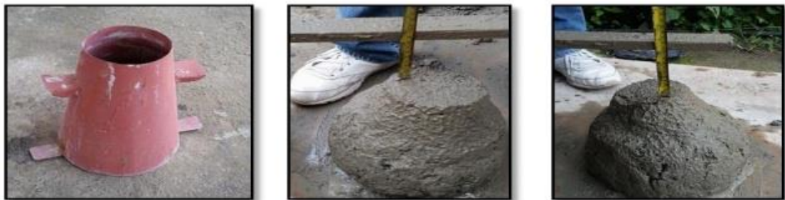
Fig.4.2. Slump cone test
