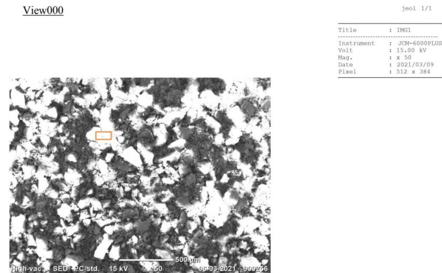
Fig: 5.10: Steel Slag SEM Image (500µm)
