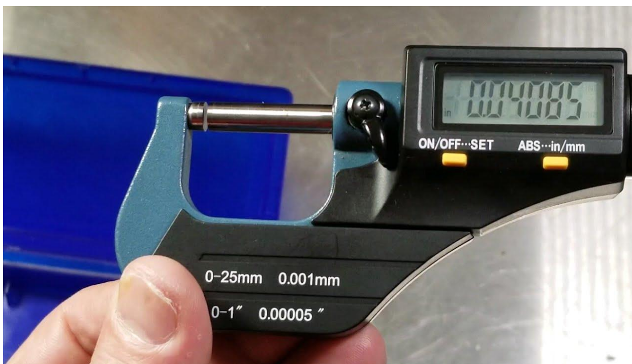
Fig:4.3 : Digital micro meter
