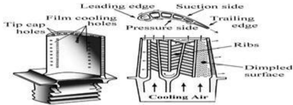
FIG: 1.4: TURBINE BLADE COOLING
