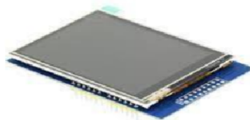
Fig:4.6 : ILI 9341 Display Module
