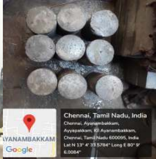
Fig:4.18 : Split Tensile Test
