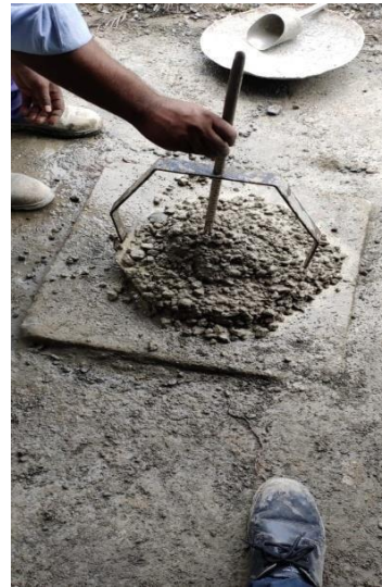
Fig: 4.15 Slump Test
