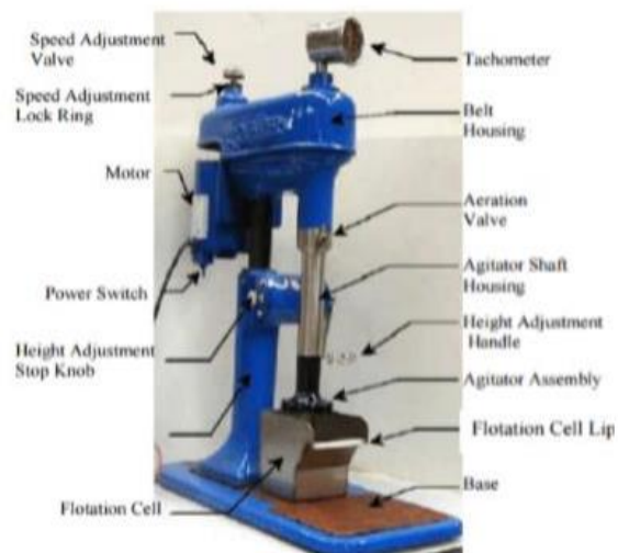
Fig.4.10. D-12 Denver flotation cell
