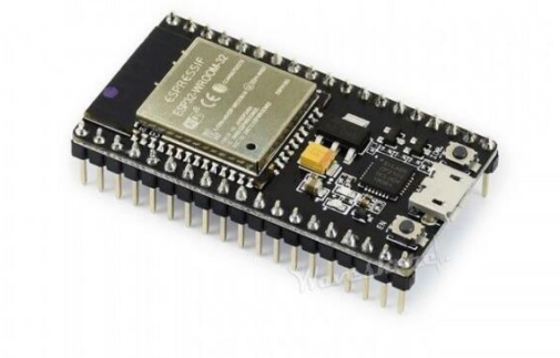
Fig 4.6. Node MCU 32S – ESP32
