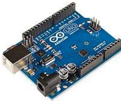
Fig 4.2.Arduino UNO REV3 SMD
