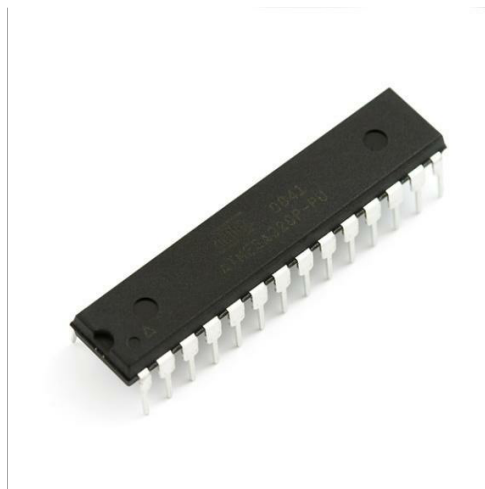
ATmega328P IC diagram fig 2.5
