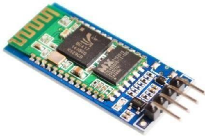
Fig 4.8 : HC05 bluetooth module
