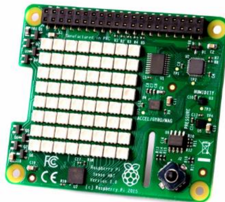
Fig. 5.22: Raspberry Pi Sense HAT
