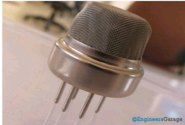
Fig:3.3.4.1: Gas sensor
