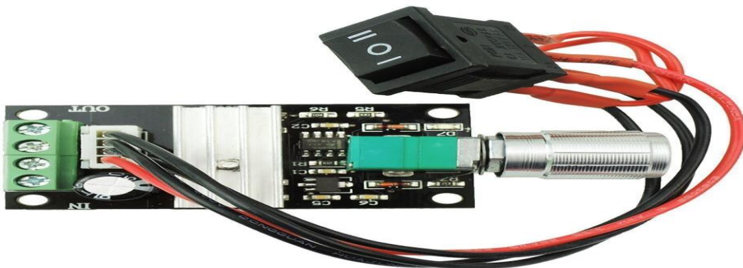
Fig:4.7: Motor Speed Controller
