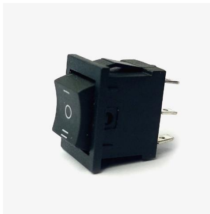
Fig:4.9: 3 Position switch
