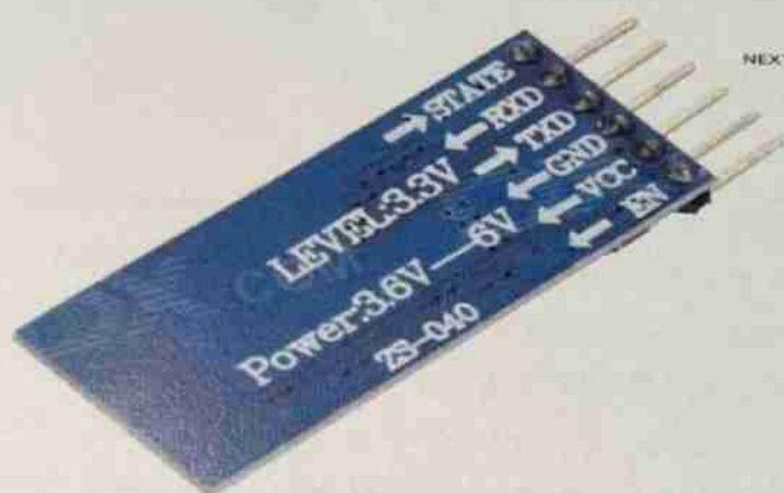
Fig 4.8 HC-05 Bluetooth Module
