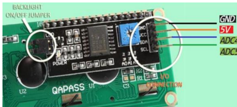
Fig:4.9 : LCD display to Arduino wiring
