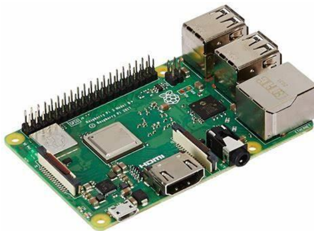
Fig:4.2 : Raspberry Pi 3 A
