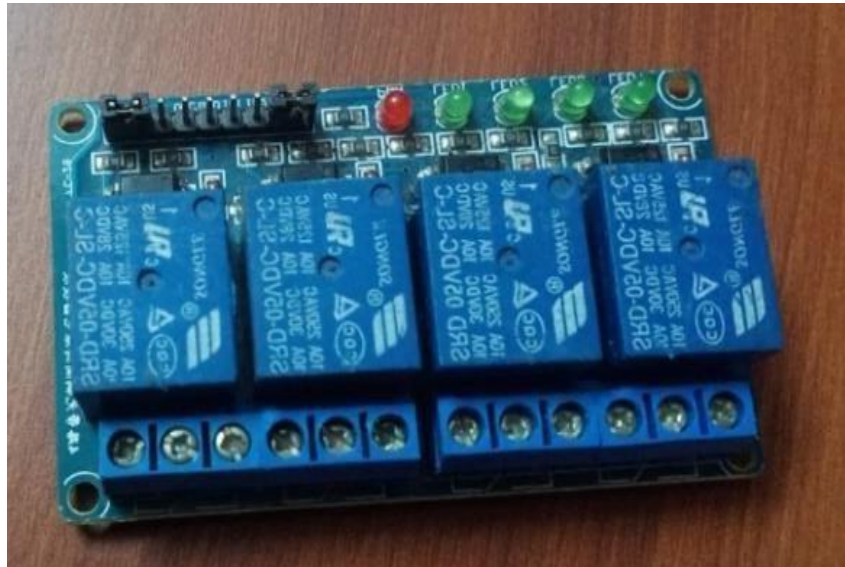
Fig:4.12 : Relay module
