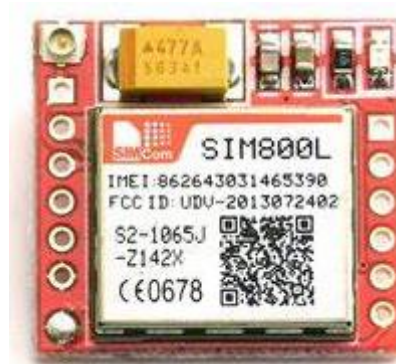
Fig. 5.7: SIM800L GSM/GPRS module
