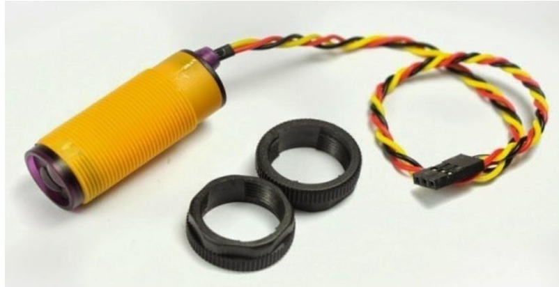
Fig: 4.4: IR Sensor
