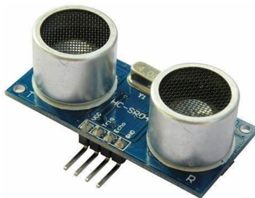
Fig No: 4.9 Ultrasonic (UV) Sensor
