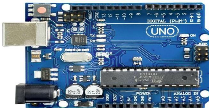
Fig 4.2 : Arduino Uno R3
