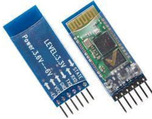
Fig 3.3 HC-05 Bluetooth module
