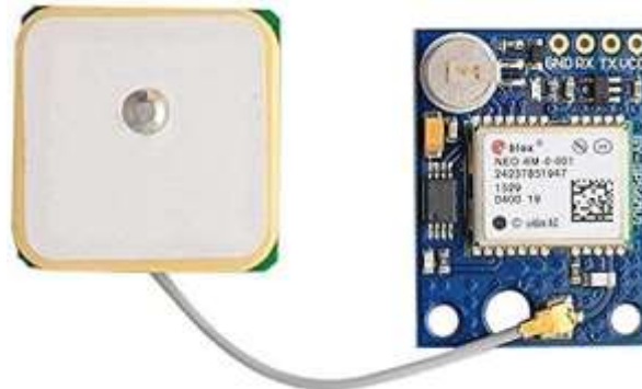
Figure 7: NEO6 GPS Module
