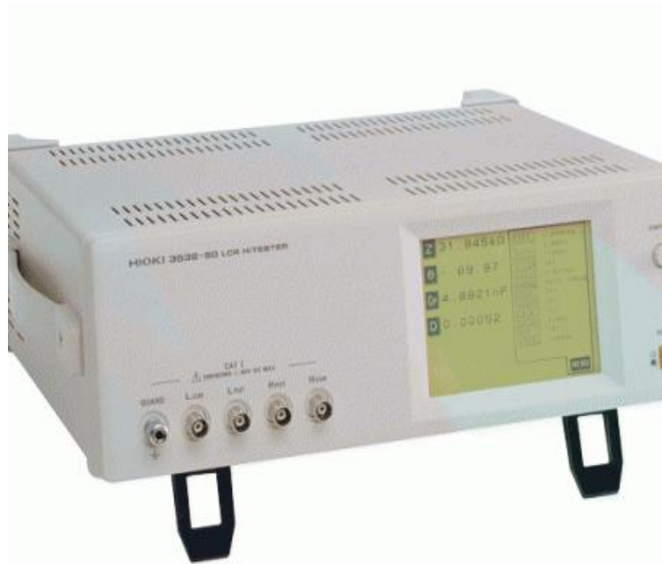
Fig 2.7 HIOKI 3532-50 HITESTER LCR METER
