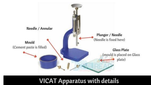
Fig 4.1 Vicat Apparatus
