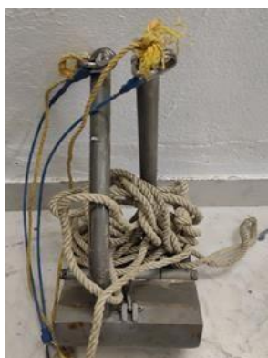
Fig: 4.3 van Veen grab sampler
