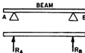
Fig. 3.6 simple/Knife edge Support
