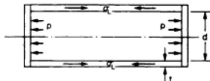
Fig. 2.16 Longitudinal failure.
