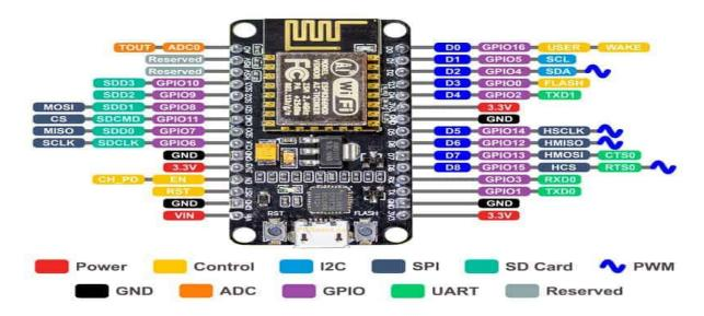
Fig. 1 ESP 8266 Components
